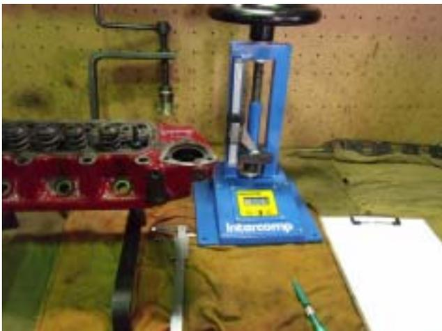
バルブリークチェック・分解・洗浄をして組み立てます。リークも無く、円も切れていて状態は良好。ベタ当りを避けてすり合わせはしません。バルブスプリングをチェック～ストリート用には丁度よさそうなレートでした。ヘッド面を仕上げ、ステムシールを交換して組み立て。
