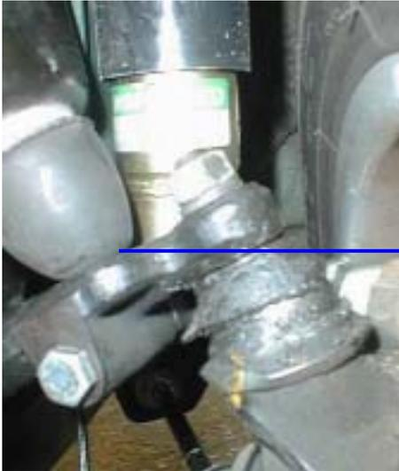
ゼロ荷重静止状態でアッパーアームとストップラバーが接触していて、サスペンションが機能していない状態。
